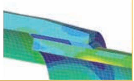
Påfrestningsanalys av limmad rörskarv
